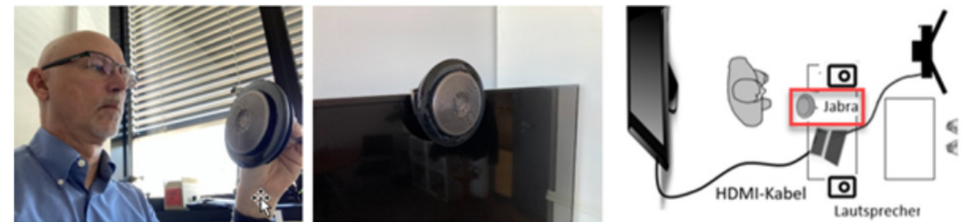
Abb. 8: Handhabung und Positionierung Raummikrofon Quelle: eigene Bilder/ eigene Grafik
